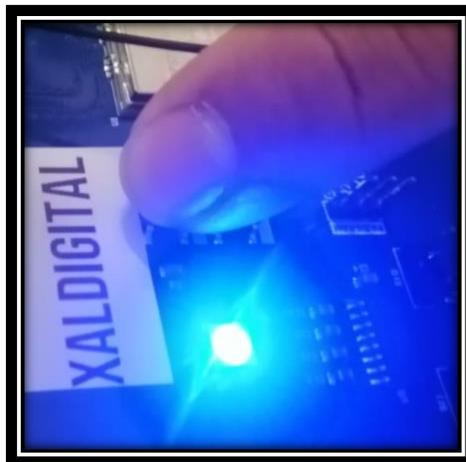
NOTA: después de haber presionado el botón de “reset” transcurrirán alrededor de 5 segundos para que el led que se encontraba en azul fijo cambie de nuevo a verde fijo, esto nos indica que el dispositivo ya esta listo para ser utilizado con las configuraciones definidas anteriormente.
