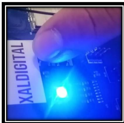
NOTA: después de haber presionado el botón de “reset” transcurrirán alrededor de 5 segundos para que el led que se encontraba en azul fijo cambie de nuevo a verde fijo, esto nos indica que el dispositivo ya está listo para ser utilizado con las configuraciones definidas anteriormente.
